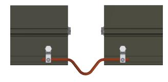
**EXPANSION JOINT USED AS THERMAL BREAK W/ GROUNDING LUGS & COPPER JUMPER**
